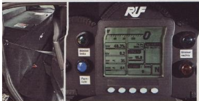
Hinter den Vordersitzen liegt der größte Batzen der Lithium-Ionen-Akkus. Monochromes Computer-Display statt Rundinstrumente
