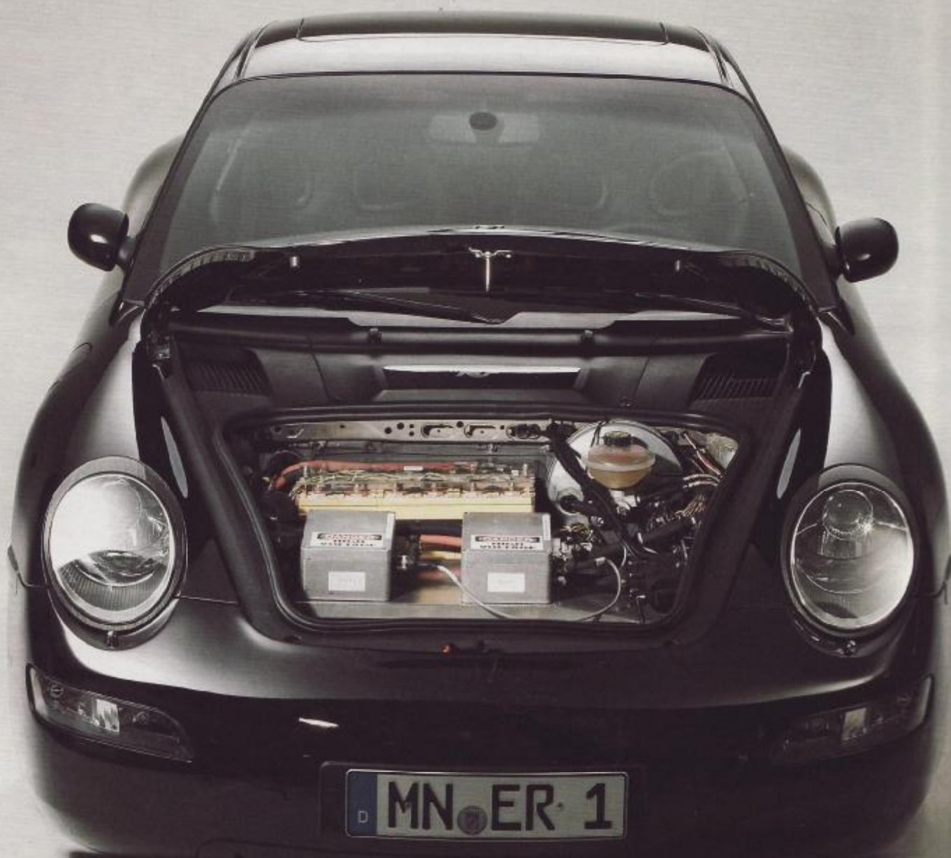
Ruf-Porsche mit Elektroantrieb 204 PS aus 96 Lithium-Ionen-Batterien
