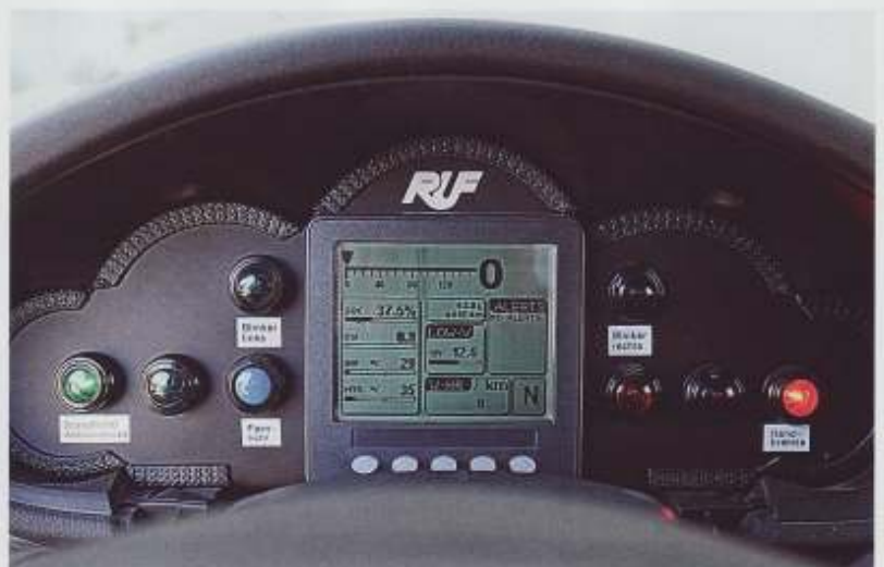
Pure Funktionalität: Digitales Kombi-Instrument und Leuchtanzeigen prägen im Moment noch das Instrumenten-Panel des Entwicklungsträgers
