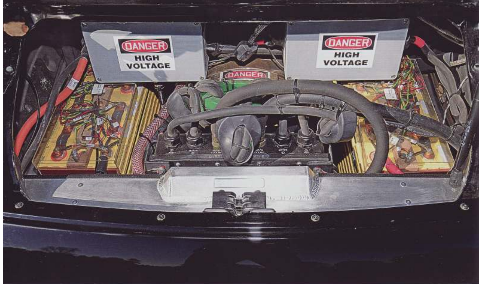
Überraschung unter der Motorhaube: Der Blick ins Elfer-Heck offenbart komplexe Elektro- anstelle üblicher Motorentechnik
